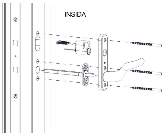
2. Vid BPK 6 TRÄ montera fast den invändiga cylindern på handtaget.
