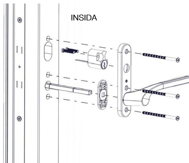
2. Vid BPK 6 TRÄ montera fast den invändiga cylindern på handtaget.
